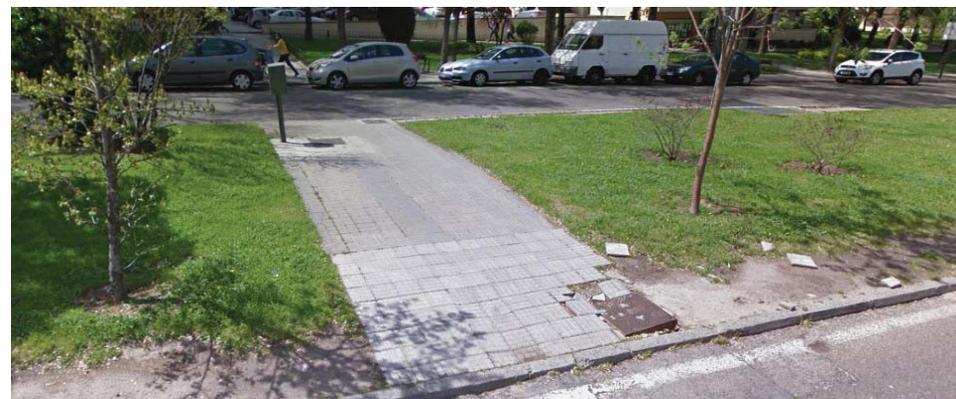
La sección de la calle es simétrica con acera de 3,25-3,40m, aparcamiento en línea de 2m, carril de circulación de 5,10-5,45m y mediana central ajardinada de 9,60m. La recogida de aguas se lleva a cabo en ambas calzadas en las delimitaciones de acera y calzada mediante pozos absorbedores.
