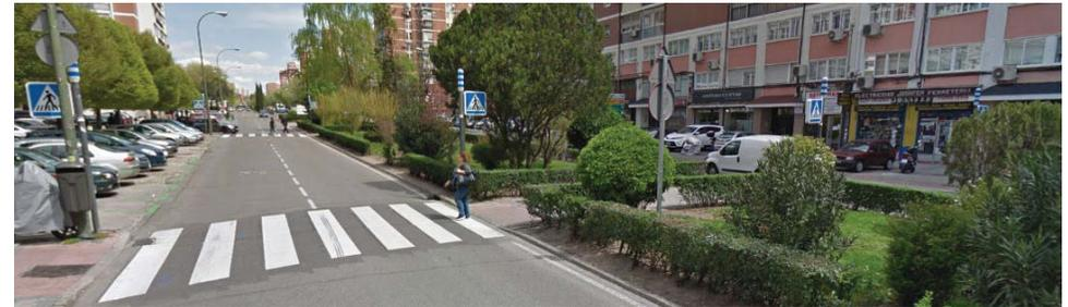
Las aceras se encuentran pavimentadas con loseta hidráulica gris de 15x15cm, fajeada con loseta hidráulica negra de cuatro pastillas de 21x21cm y delimitadas con bordillo de hormigón prefabricado tipo III de plinto variable entre 8-12 cm con un estado de conservación adecuado.
