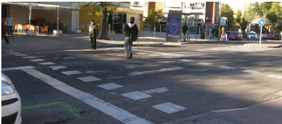
Las aceras anexas se encuentran pavimentadas con loseta hidráulica gris de 15x15cm, fajeada con loseta hidráulica negra de cuatro pastillas de 21x21cm y delimitadas con bordillo de hormigón prefabricado tipo III de plinto variable entre 10-12 cm con un estado de conservación adecuado.
