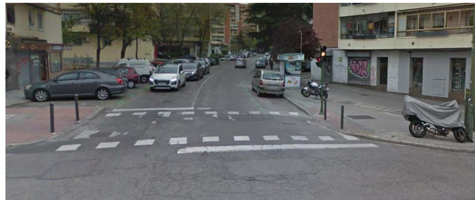
Las aceras anexas se encuentran pavimentadas con loseta hidráulica gris de 15x15cm, fajeada con loseta hidráulica negra de cuatro pastillas de 21x21cm y delimitadas con bordillo de hormigón prefabricado tipo III de plinto variable entre 10-12 cm con un estado de conservación adecuado.
